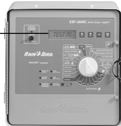
7. Si la pantalla muestra “SHORT M1”, “OPEN M1”, “SHORT M2” u “OPEN M2”, puede haber un circuito dañado entre el controlador y la válvula maestra. (En sistemas de riego no equipados con una válvula maestra, el indicador “OPEN M1” u “OPEN M2” es normal y no requiere de servicio).
