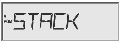
2. Si el programa que usted desea utilizar no es el que se muestra en la pantalla, presione PGM (PROG.) hasta que aparezca.
