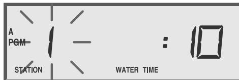
Si la estación está incluida en otro programa, el controlador le avisará substituyendo la duración de riego con la palabra USED (USADO).
